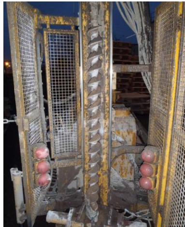
Photographies des carottes/tarières/gouges
