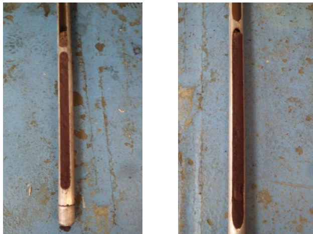
Photographies des carottes/tarières/gouges
