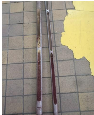
Photographies des carottes/tarières/gouges
